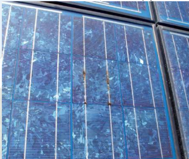
Fig. 1. Exemplu de modul fotovoltaic defect
