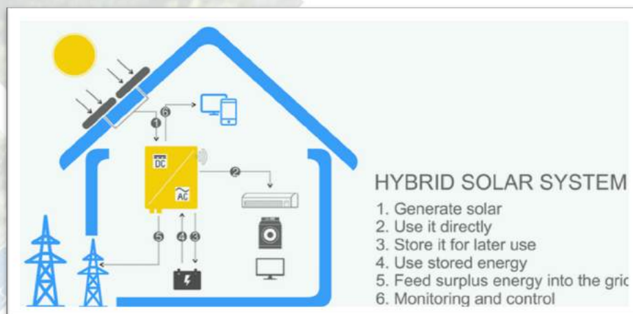
Fig. 7. Stocarea energiei în sistemul fotovoltaic cu inverter, unde: Sistem fotovoltaic hibrid: 1) Generator solar, 2) Consum direct de energie; 3) Stocare de energie pentru o utilizare ulterioară; 4) Consumul de energie stocată; 5) Excedentul energetic trimis în rețea; 6) Monitorizare și control
