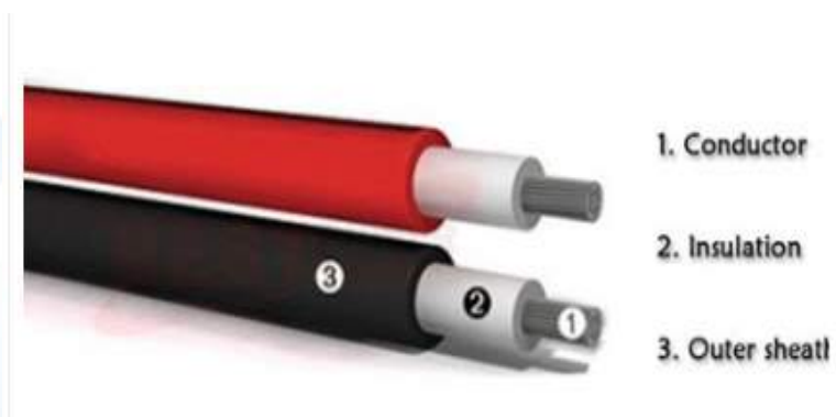
Fig. 3. Structura cablului fotovoltaic, unde: 1. Conductor flexibil din cupru flexibil (conductoare), 2. Primul strat de izolație, cauciuc fără halogeni, LSZH alb (Izolație), 3. Al doilea strat de izolație, cauciuc fără halogeni, împiedicând propagarea flăcării, fără fum. Negru sau roșu (manta exterioară).
