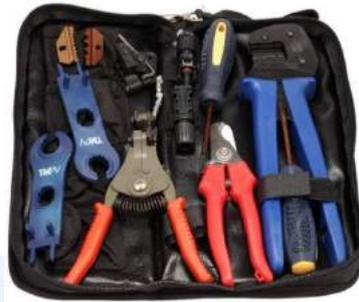
Fig. 3. Conjunto de herramientas para conectores fotovoltaicos.
