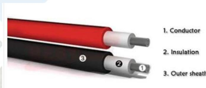
Fig. 3. Estructura del cable fotovoltaico, donde: 1. Conductor de cobre flexible de múltiples hilas (conductor), 2. Primera capa de aislamiento, caucho libre de halógenos, blanco LSZH (aislamiento), 3. Segunda capa de aislamiento, goma libre de halógenos, que evita la propagación de las llamas, libre de humo. Negro o rojo (funda exterior)
