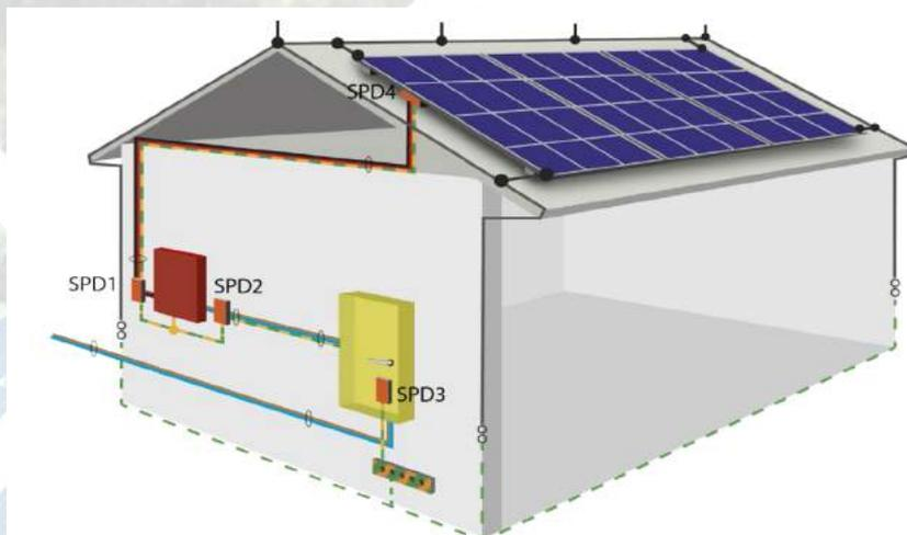
Fig. 8. Instalación de rayos
