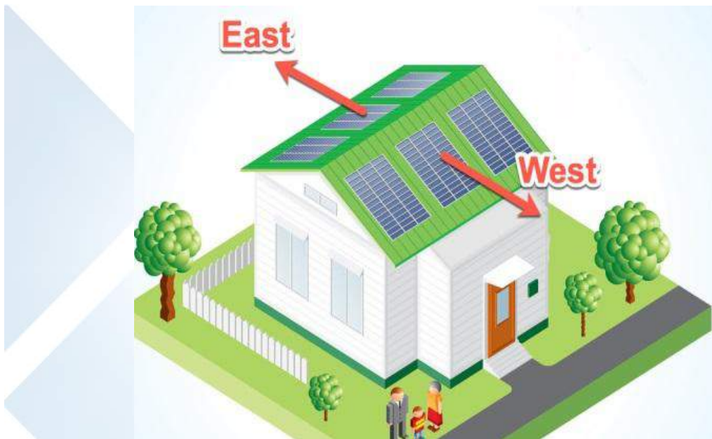
Εικόνα 3. Εγκατάσταση μονάδων που βλέπουν Ανατολή –Δύση
