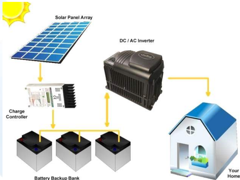
Fig. 7. Inversor OFF-GRID en la instalación fotovoltaica
