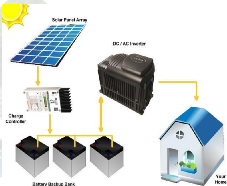
Rys. 7. Falownik Off grid w instalacji PV
