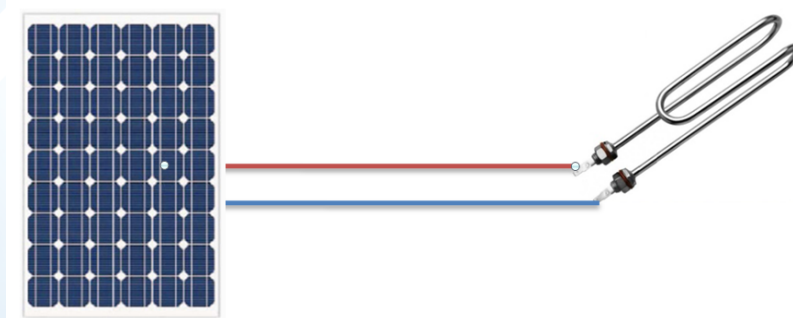
Rys. 1. Przykład systemu zasilającego bezpośrednio odbiorniki
