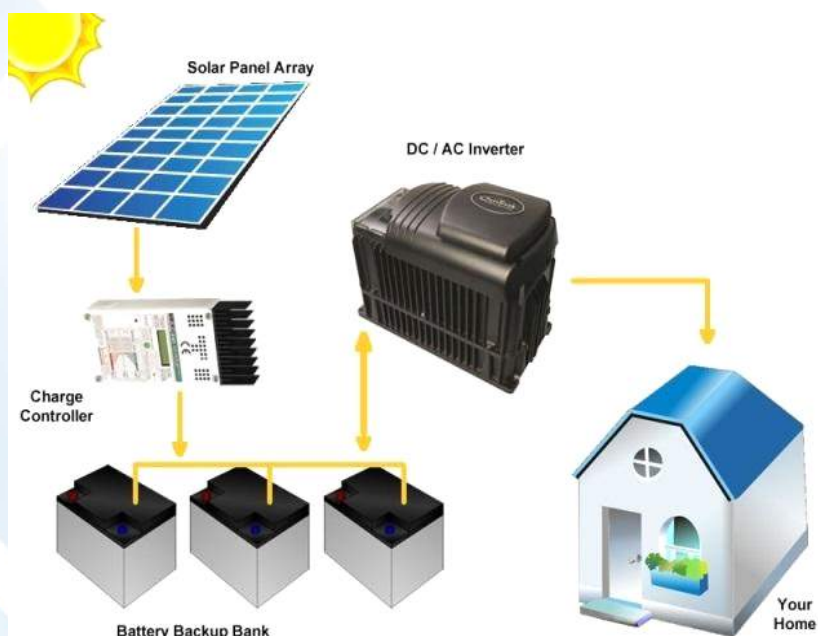
Fig. 7. Invertorul OFF-GRID din instalația fotovoltaică
