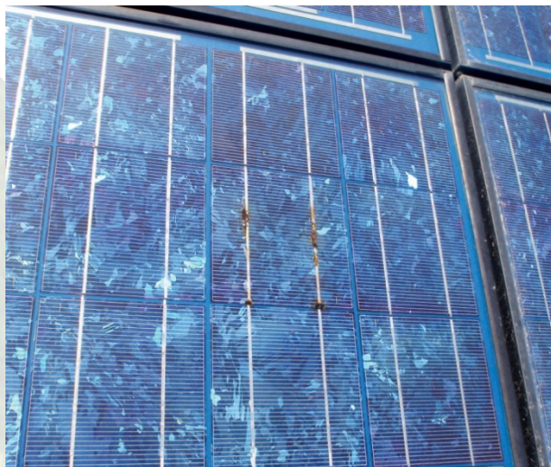
Rys. 1. Przykład rozszczelnionego modułu fotowoltaicznego
